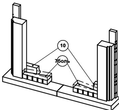
5) Установите детали 6 и 11 согласно приведенным размерам. Если Вы приобрели широкую топку, детали 6 вплотную поставьте к деталям 2.
